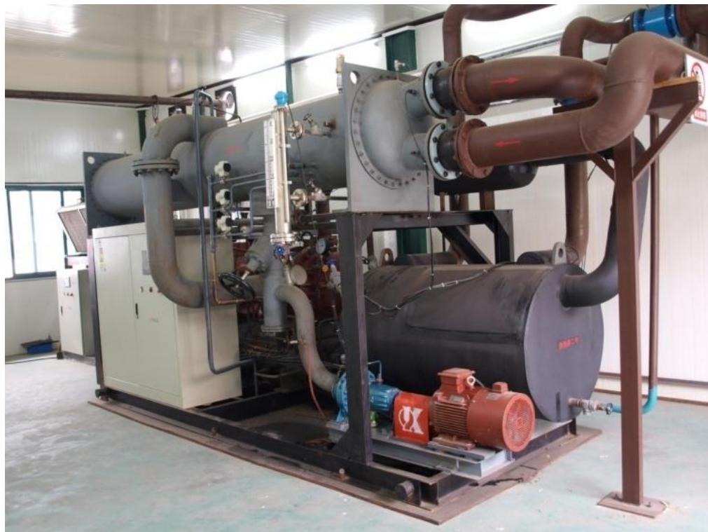
160kW热水型ORC螺杆膨胀发电机组试验站台
