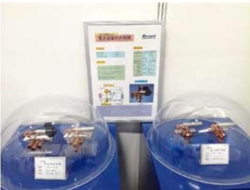
图2-103 伊兹米公司的多功能集约控制阀
