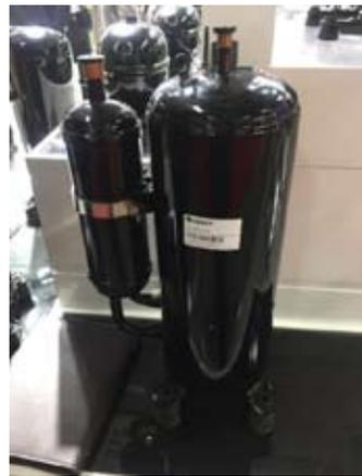
图2-7格力双缸多排气压缩机
