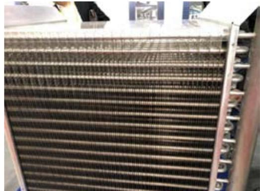
图2-88 德默菲变翅片间距换热器
