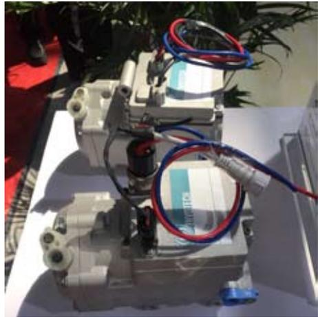
图2-10 电动汽车空调压缩机
