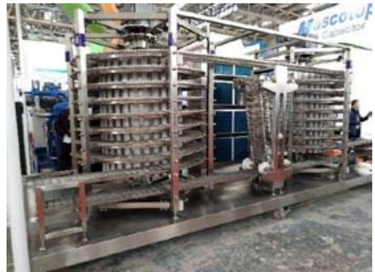
图2-71 螺旋式速冻机
