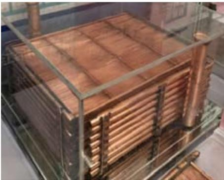
图2-96 金丝通围叠式微通道换热器
