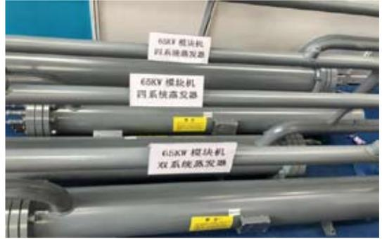
图2-77 双系统/四系统蒸发器
