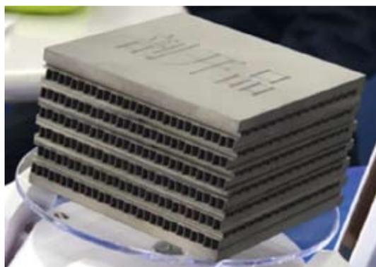
图2-92 沈氏微通道换热器结构剖开图
