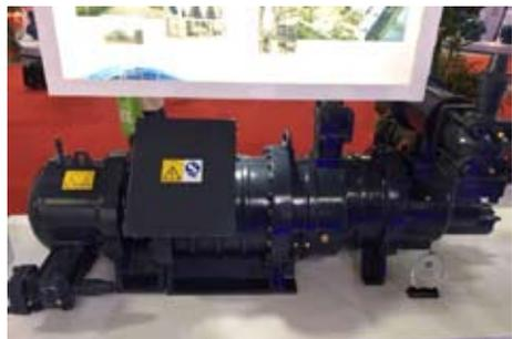
图2-11汉钟余热回收压缩机
