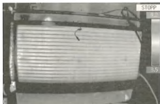
图 4.3-20 不带自循环的系统换热器逆流换热时表面温度分布
