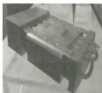
图 2.3-4 热管冷凝段强化式
