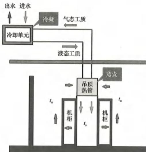
图 4.2-3 顶置式热管运行原理图
