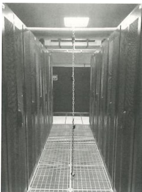
图 5.4-6 机柜进风区域内沿中心高度方向的测试点位布置
