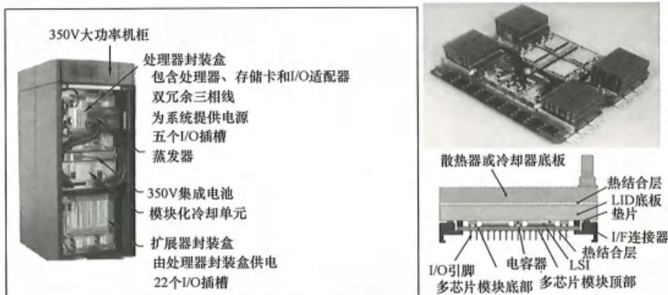
图 2.1-13 IBM 与 Fujitsu 高端服务器的低温冷却设计
