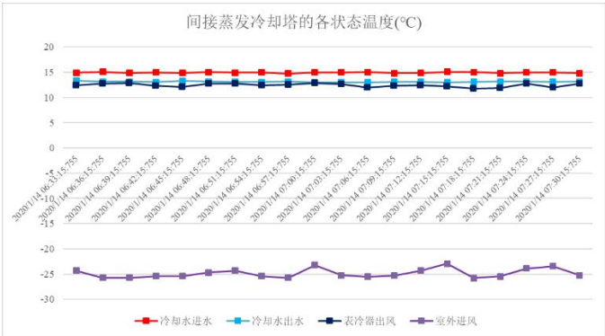
图 15. 2020 年 1 月典型日的间接蒸发冷却塔运行状态
